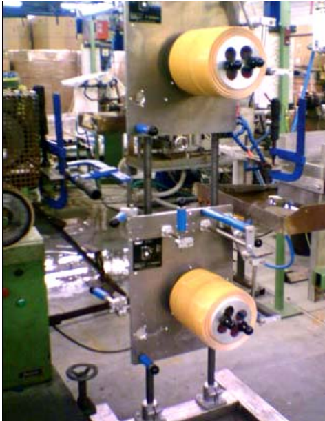
Extrudierte PVC Dichtungen für Rollläden Gleichzeitige Applikation von 2 Klebestreifen mit 2 Abrollern auf dem Gestell
