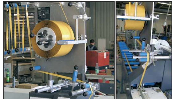
Aluminium Profile – Laminierung des Klebebandes außerhalb der Produktion, nach dem Schneiden
