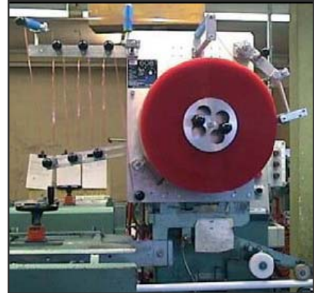
Aluminium Rohre – Laminierung während des Schneideprozesses
