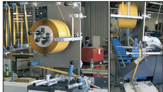
Aluminium Profile – Laminierung des Klebebandes
